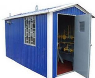
ГРПШ, газорегуляторные установки и пункты газорегуляторные блочные (в дальнейшем пункты) предназначены для редуцирования высокого или среднего давления на требуемое, автоматического поддержания заданного выходного давления независимо от изменения расхода и входного давления, автоматического отключения подачи газа при аварийном повышении или понижении выходного давления от допустимых заданных значений, очистки от механических примесей газа, поставляемого по ГОСТ 5542–87.
